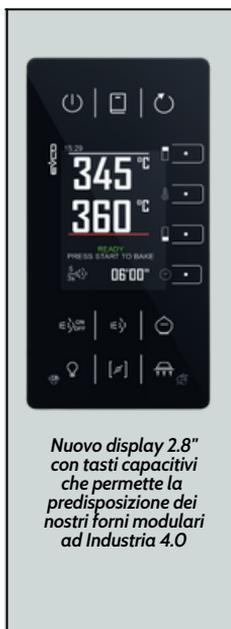
*Nuovo display 2.8" con tasti capacitivi che permette la predisposizione dei nostri forni modulari ad Industria 4.0*
